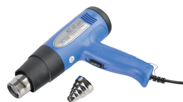
PISTOL AER CALD • Putere: reglabilă, între 750W - 1500W • Temperatura jetului de aer reglabilă: 180 °C - 500 °C
